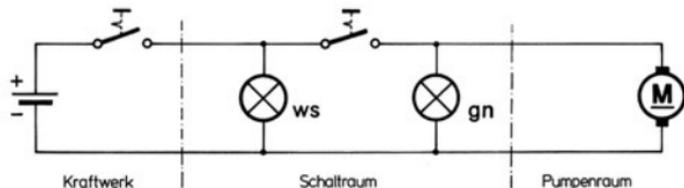
Die weiße Lampe leuchtet auf, wenn der Hauptschalter eingeschaltet ist. Die Anlage ist damit betriebsbereit. Der Motor läuft erst, wenn der Schalter auf der Schalttafel ebenfalls eingeschaltet ist. Die grüne Signallampe zeigt dies an.
