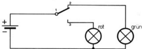
Dazu brauchst Du sicher keinen besonderen Verdrahtungsplan. Es leuchtet entweder die grüne oder die rote Lampe. Du „tastest“ von „grün“ auf „rot“ um. Daher die Bezeichnung: „Umschalt-Taster“. Viele sagen auch „Wechsler“ dazu.
