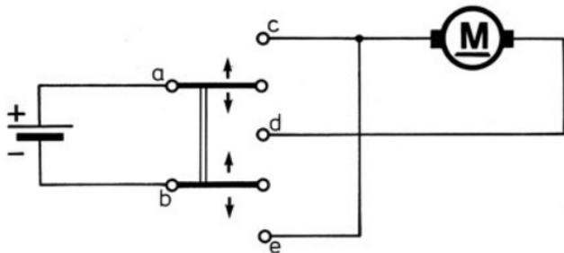
In der oberen Schalterstellung ist a mit c und b mit d verbunden. In der unteren Stellung hat dagegen a mit d und b mit e Verbindung. Da e mit c verbunden ist, ist in der oberen Stellung des Schalters der linke Motoranschluß mit + und der rechte mit dem – Pol der Batterie verbunden. In der unteren Stellung ist es genau umgekehrt: Die Mittelstellung entspricht Aus.
