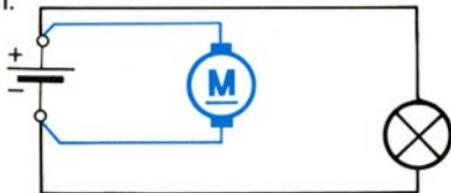
Ohne weitere Ausführungen ist klar, daß in diesem Bild zwei Stromkreise beteiligt sind, einer für den Motor und einer für die Lampe. Zum Betrieb könnte man zwei verschiedene Batterien verwenden, doch kann man auch ein und dieselbe auch für beide Verbraucher, die Lampe und den Motor, verwenden. Anschlußmöglichkeiten sind genug vorhanden – so enthält beispielsweise der Batteriestab je drei Plus- und Minusbuchsen.
