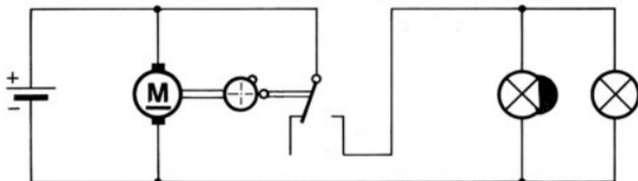
Die Lampen sind so geschaltet, daß sie gleichzeitig aufleuchten, Sie sind also „parallel geschaltet“. Nocken und Taster werden so eingerichtet, daß das Aufblitzen der Lampen gerade dann erfolgt, wenn sie sich ganz nahe stehen. (Achtung: Die Lampen dürfen sich nicht berühren oder gar aneinander schlagen!)
