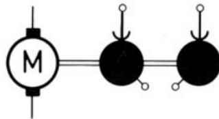
Schaltzeichen eines 2-poligen Schleifringes mit Antriebsmotor.
