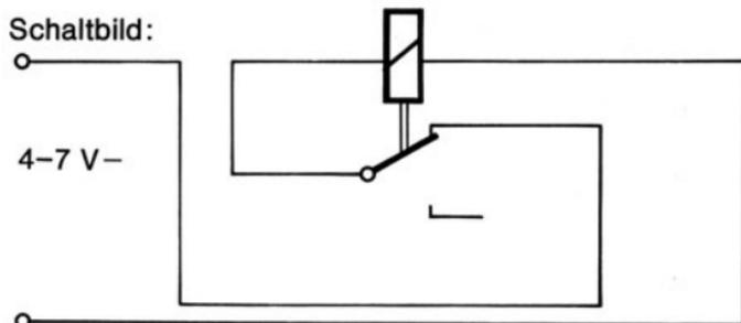
Schaltet man ein, so fließt genau wie beim letzten Modell Strom durch die Magnetwicklung. Der Anker wird angezogen und die Kontaktzunge nach unten gedrückt. Und nun beginnt dasselbe Spiel wie beim Pendel (Seite 52), nur viel schneller!
