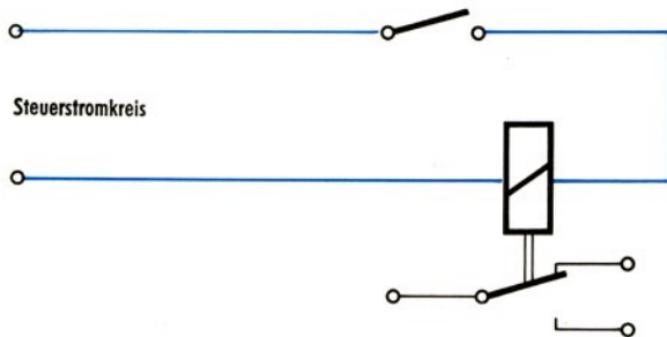
Den Umschaltkontakt kannst Du auch wahlweise als „Ruhekontakt“ und als „Arbeitskontakt“ benutzen. Es wird Dir keine Schwierigkeiten machen, über den Ruhekontakt eine weiße Signallampe anzuschalten. Diese muß also leuchten, wenn kein Strom über die Relaispule fließt. Genau das Umgekehrte tritt ein, wenn Du die Signallampe über den Arbeitskontakt anschaltest.
