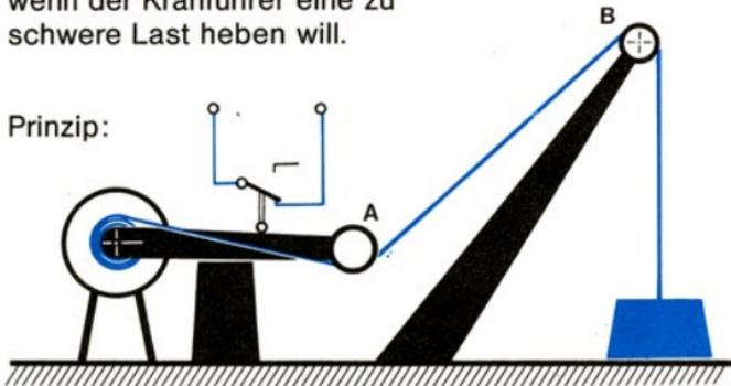
Schaltet man den Motor (in die richtige Drehrichtung) ein, so wird das zunächst etwas lose Seil auf die Trommel aufgespult, bis es angespannt ist. Erweist sich nun die Last als zu schwer, so wird nicht diese angehoben, sondern der um die Seiltrommel drehbare Hebel mit der Umlenkrolle A. Dieser Hebel betätigt den darüber angeordneten Taster und schaltet den Motor aus. Braucht man dazu einen Aus- oder einen Ein-Taster?
