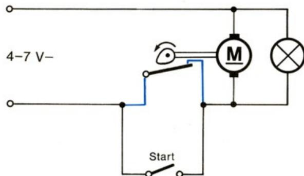
Vielleicht hast Du noch kein Netzgerät. Deshalb sollst Du für die Auswahl folgendes wissen: Beim mot. 4-Netzgerät kannst Du die Höhe der Gleichspannung einstellen. Je weiter Du den Drehknopf aus der Mittelstellung nach links oder nach rechts drehst, um so höher wird die Spannung an den Gleichspannungsbuchsen. Damit kann die Drehzahl und die Drehrichtung des Motors verändert oder die Helligkeit von Lampen eingestellt werden.
