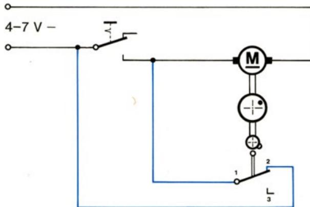
Der Hauptschalter überbrückt den vom Nocken gesteuerten Taster. Ist dieser eingeschaltet, so läuft der Motor auf jeden Fall. Schaltet man ihn aber aus, so läuft er noch so lange weiter, bis der Nocken den Taster drückt.
