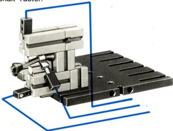
Es ist wichtig, daß die federnde Kontaktzunge im Ruhezustand etwas gegen das obere Kontaktstück drückt. Zur Befestigung auf der Grundplatte kannst Du auch ein Verbindungsstück 15 nehmen.
