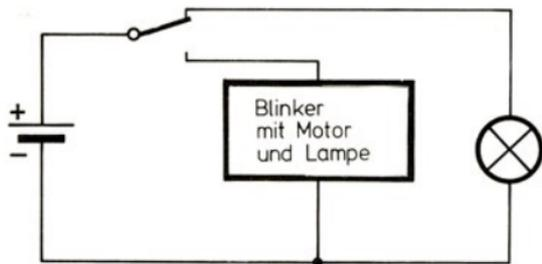
Den angedeuteten Blinker kannst Du z. B. durch eine motorgetriebene Nockenscheibe und einen fischertechnik-Taster selbst konstruieren.
