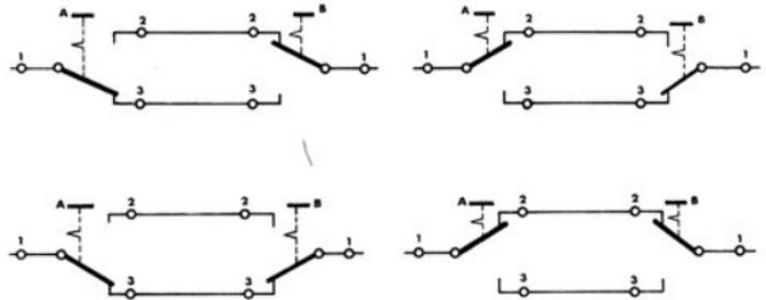
Man braucht jetzt nur noch zu überlegen, wann der Strompfad unterbrochen ist und wann nicht. Wie Du Dich überzeugen kannst, erfüllt diese Schaltung genau die Aufgabe, die wir uns gestellt haben. Welchen Schalter man auch betätigt – die gerade brennende Lampe wird ausgelöscht bzw. die Lampe leuchtet auf. Ergänze das Schaltbild durch eine Stromquelle und eine Lampe.
