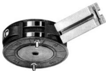
Wenn sich der Schleifring dreht, so heben die aus Isoliermaterial bestehenden Unterbrecherstücke die Schleifkontakte von der Schleifbahn ab. Dadurch wird der Stromkreis unterbrochen. Jedes Stück überdeckt einen Winkel von  $60^\circ$ , unterbricht also  $1/6$  eines Umlaufs. Du kannst zwischen der „einseitigen“ und der „zweiseitigen“ Ausführung wählen. Erstere deckt nur eine Schleifbahn, letztere beide gleichzeitig.
