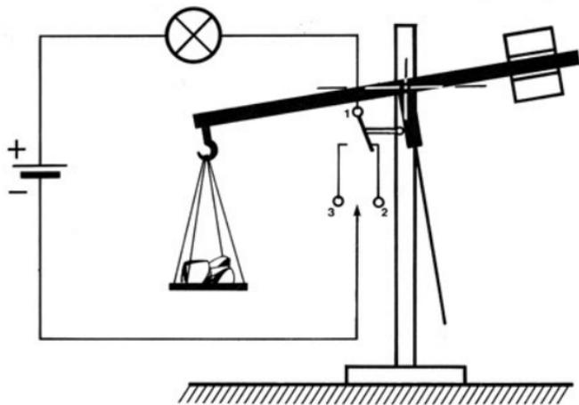
Frage: Mußt Du die von der Batterie kommende Leitung an Buchse 2 oder an Buchse 3 Deines Tasters anschließen, wenn die Lampe leuchten soll, sobald das gewünschte Gewicht auf die Schale aufgelegt ist? Kannst Du eine zweite Lampe anschließen, die anzeigt, daß noch nicht genügend aufgelegt ist?
