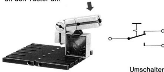
Jetzt ist aus dem „Umschalt-Taster“ ein „Umschalter“ geworden! Durch die Hebelanordnung ist die in den Taster eingebaute „Rückstellfeder“, die die rote Taste nach außen drückt, unwirksam gemacht worden. Deshalb findest Du im Schaltzeichen wieder das Rast-Symbol.
