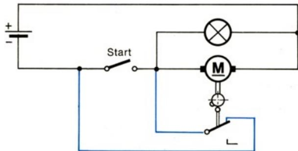
Es gibt in der Schaltung 2 Möglichkeiten, den Strom einzuschalten. Einmal durch Druck auf den Ein-Taster, zum anderen durch den Nockengesteuerten Taster. Beide sind parallel zueinander geschaltet; es ist also gleichgültig, welcher von beiden den Strom fließen läßt.
