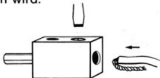
Nun wird das blank Stückchen Litze, so wie es das Bild zeigt, verdreht und dann umgelegt. Man dreht die Schraube eines Steckers mit einem kleinen Schraubenzieher etwas auf, steckt das vorbereitete Kabel hinein und zieht die Schraube wieder an – aber bitte nicht zu fest!
