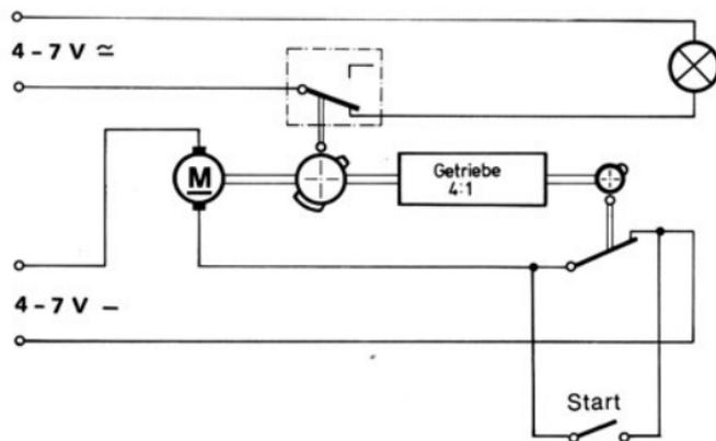
Kannst Du die Schaltung so umbauen, daß die Signallampe bei stillstehendem Motor auch dann nicht leuchtet, wenn der fischertechnik-Taster den Lampenstromkreis nicht unterbricht? Hinweis: Du darfst nur mit einer Energiequelle, der Gleichspannungsquelle arbeiten. Du mußt also die Lampe und den vom Nocken betätigten Taster in den Motorstromkreis einfügen.
